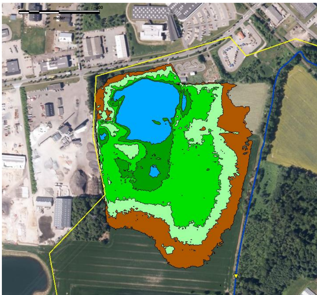
Figur 5.4.1 De fremtidige afvandingsforhold såfremt markdrænene afbrydes og vandstanden hæves til det maksimale niveau, der ikke påvirker udenfor projektområdet.
